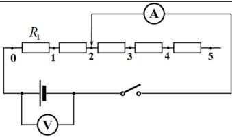
Затем, изменяя количество n включенных в электрическую цепь резисторов  $R_1$  от 0 до 5, старшеклассники записывали показания вольтметра и амперметра. По результатам измерений была составлена следующая таблица:
